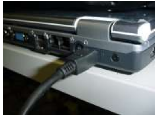
Ilustración 6. Cable Firewire conectado al portátil
